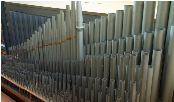
Abb. 3: Windlade mit Orgelpfeifen
