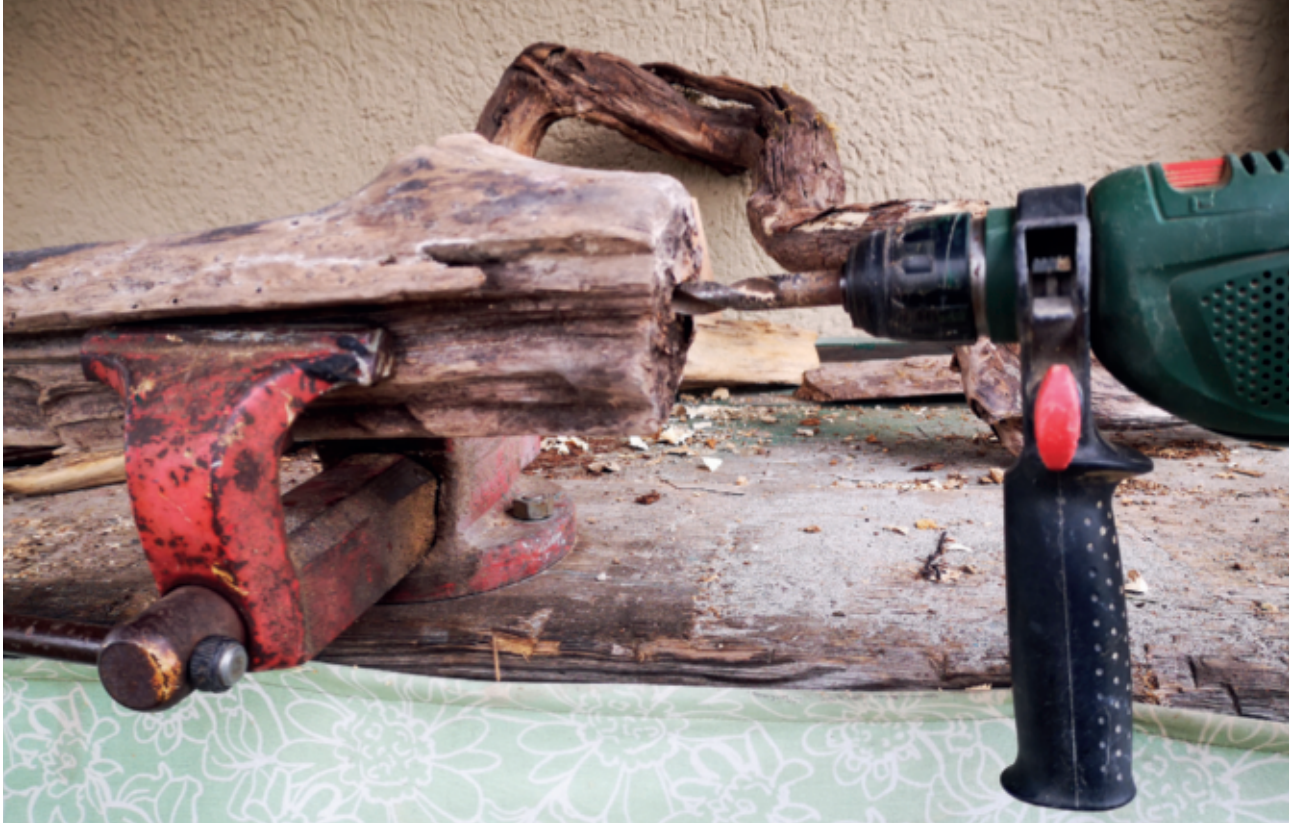
Beim Bohren das Treibholz sicher in einem Schraubstock einspannen.
