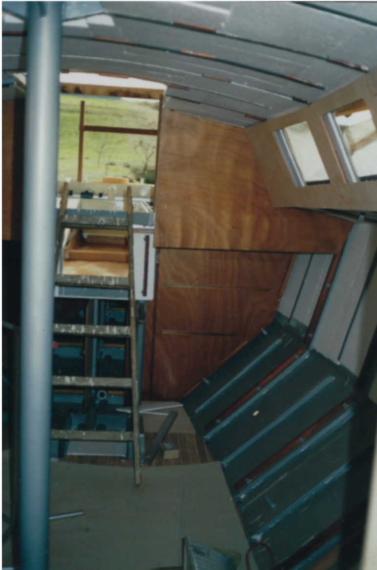
Nachdem der Deckaufbau - Marke „Reinke Taranga“ - auf den Rumpf aufgesetzt, der Innenausbau, die Malerarbeiten sowie die Grundierung beendet waren.
