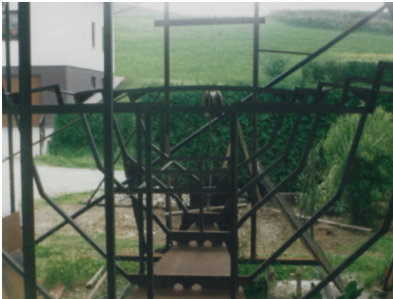
Oben: Unterm Flugdach in unserem Garten standen die Helgen bereit für den Unterbau der Bodenplatte! Unten: Hier wurden bereits die Spanten an der Bodenplatte für die Rumpfform befestigt.
